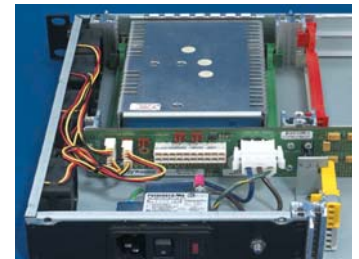
Power Input Module
